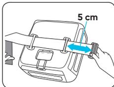
Stellen Sie das Unterteil des Reinigungselements umgedreht auf eine ebene Oberfläche und führen Sie das Befestigungsband durch die beiden silbernen Schnallen (wie abgebildet). Die Seite mit dem Klettverschluss zeigt zum Gerät.
