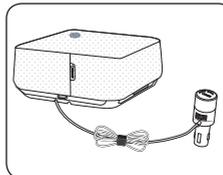
Rollen Sie etwaiges Restkabel auf und befestigen Sie es mit dem mitgelieferten Kabelbinder.
