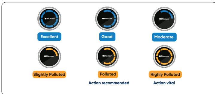
Die Luftqualität im Hinblick auf Partikel (PM<sub>2.5</sub>) wird durch eine Farbe am Einstellknopf angezeigt. Detaillierte Daten werden in Echtzeit in der App „Blueair Friend“ dargestellt.
