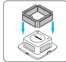
2. Bringen Sie den auseinandergefalteten Filter auf dem Unterteil des Reinigungselements an.
