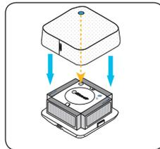
3. Montieren Sie den Deckel wieder auf das Unterteil des Reinigungselements.
