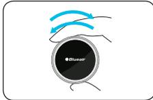
Um das Gerät einzuschalten, drehen Sie einmal nach rechts oder links.
