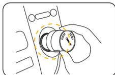
Der Einstellknopf wird in den 12 V-Stromanschluss in der Steuerkonsole des Autos gesteckt.
