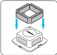
1. Heben Sie den Deckel ab und montieren Sie den neuen Filter auf das Unterteil des Reinigungselements.
