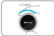
Drehen Sie den Einstellknopf gegen den Uhrzeigersinn und halten Sie ihn für 3 Sekunden, bis die Leuchtanzeigen ausgehen.
