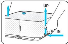
1. Stellen Sie das Reinigungselement auf eine ebene Oberfläche oder auf einen Autositz und lösen Sie den Deckel, indem Sie die links und rechts befindliche Entriegelung HINEIN und NACH OBEN drücken wie abgebildet.
