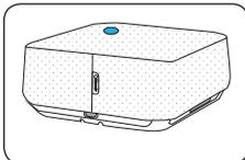
4. Schalten Sie das Gerät ein - (eine blaue LED-Anzeige auf dem Deckel leuchtet auf, um anzuzeigen, dass das Gerät eingeschaltet ist).
