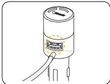
An einem USB-Ladeanschluss am Einstellknopf können Fahrer bzw. Beifahrer ein weiteres Gerät anschließen und aufladen (z. B. ein Handy).
