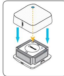
5. Montieren Sie den Deckel wieder auf das Unterteil des Hauptgeräts.
