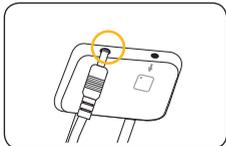
Das andere Ende des Kabels wird in den Stromanschluss am Hauptgerät gesteckt.
