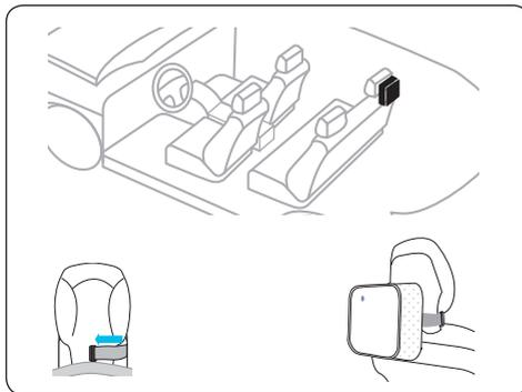
Befestigen Sie das Gerät fest hinter der Kopfstütze eines Rücksitzes, indem Sie das Befestigungsband entsprechend einstellen.
