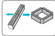
1. Entfernen Sie die Kunststofftüte, die den Filter umgibt, und ziehen Sie die beiden Seiten des Filters auseinander, sodass ein Quadrat entsteht.
