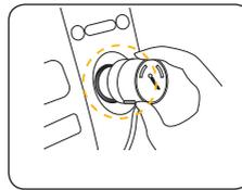
Verbinden Sie den Einstellknopf über den 12 V-Stromanschluss in der Nähe des Fahrers mit der Stromversorgung. (Näheres dazu finden Sie auf Seite 5).
