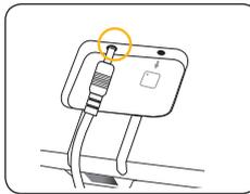
Verbinden Sie das Stromkabel mit dem Stromanschluss an der Rückseite des Geräts, bevor Sie das Gerät im Auto installieren.
