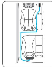
Lassen Sie das Kabel zwischen dem Einstellknopf und dem Gerät unter Teppichen oder anderen Kunststoffelementen entlanglaufen. Um Kabelschäden beim Einstellen der Autositze zu vermeiden, lassen Sie es nicht zu nahe an den Sitzschienen verlaufen.
