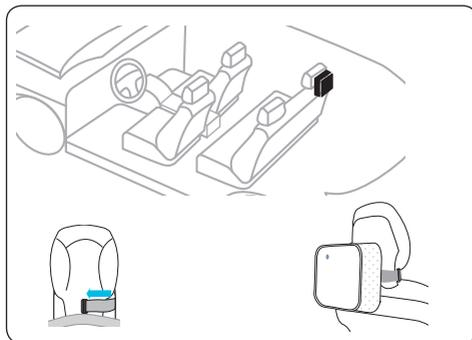
Befestigen Sie das Gerät fest hinter der Kopfstütze eines Rücksitzes, indem Sie das Befestigungsband entsprechend einstellen.
