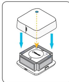
5. Montieren Sie den Deckel wieder auf das Unterteil des Hauptgeräts.
