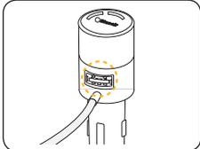
An einem USB-Ladeanschluss am Einstellknopf können Fahrer bzw. Beifahrer ein weiteres Gerät anschließen und aufladen (z. B. ein Handy).
