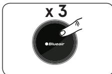
Drücken und halten Sie den Einstellknopf 3 Sekunden lang. Alle eingeschalteten LEDs gehen binnen 2 Sekunden aus.
