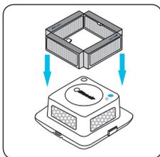
1. Heben Sie den Deckel ab und montieren Sie den neuen Filter auf das Unterteil des Reinigungselements.
