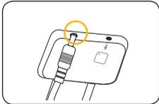
Das andere Ende des Kabels wird in den 12 V-Stromanschluss am Hauptgerät gesteckt.
