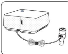
Rollen Sie etwaiges Restkabel auf und befestigen Sie es mit dem mitgelieferten Kabelbinder.
