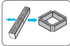
1. Entfernen Sie die Kunststofftüte, die den Filter umgibt, und ziehen Sie die beiden Seiten des Filters auseinander, sodass ein Quadrat entsteht.
