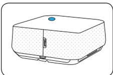
3. Schalten Sie das Gerät ein - keine blaue LED-Anzeige auf dem Deckel leuchtet auf, um anzuzeigen, dass das Gerät eingeschaltet ist).
